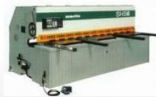
コマツシャーリング 5000mmのワークの幅落とし可能
